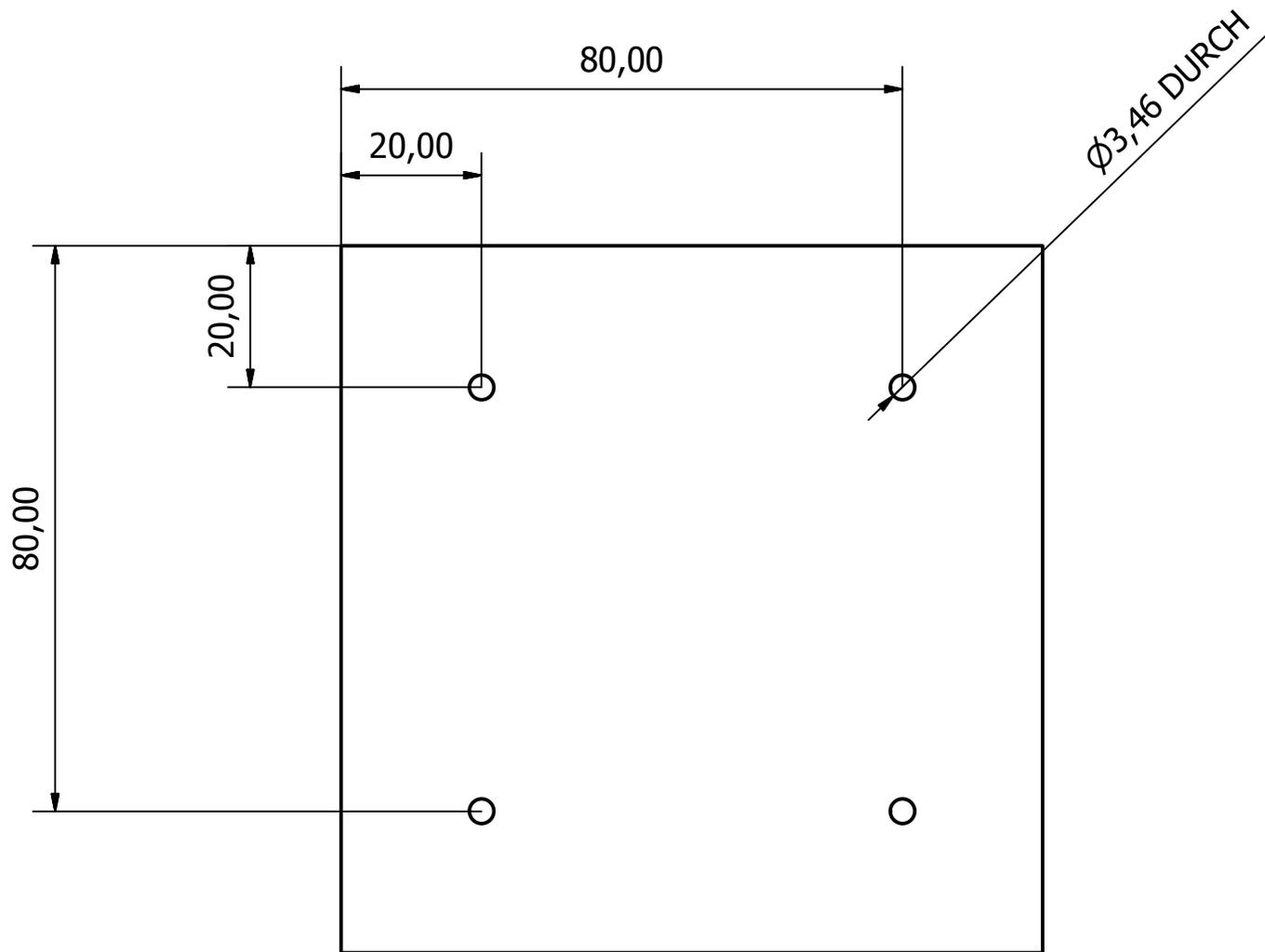
Bohrungen in eingereichten Kühlkörper 100x100
