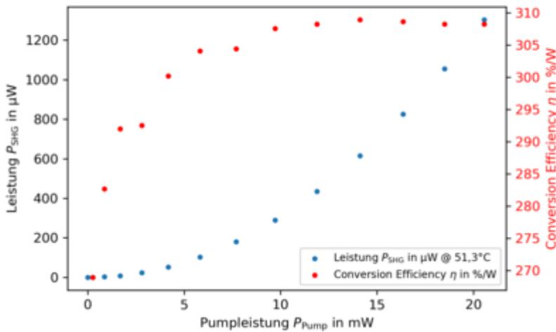
Im Datenblatt wird 51.3 als optimale Betriebstemperatur angegeben. Für diese Temperatur wird die Abhängigkeit der Ausgangsleistung des SHG sowie der conversion efficiency von der Pumpleistung untersucht.
