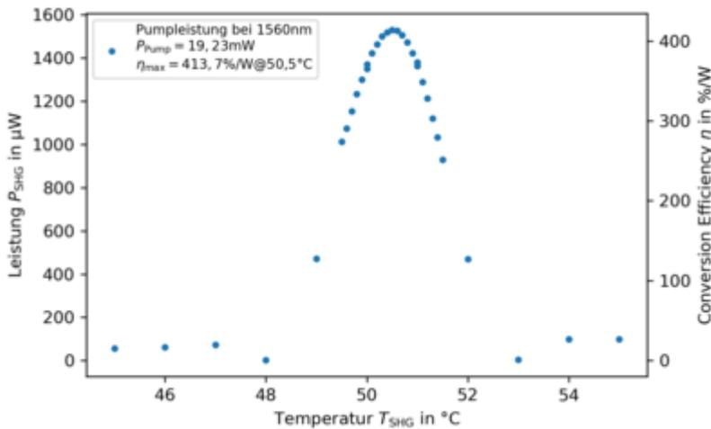
Der Laser wird auf 123.5 mA bei 17.5°C eingestellt und liefert eine Pumpleistung von 19.23 mW bei 1560 nm. Unter diesen Bedingungen wird die Temperaturabhängigkeit der Ausgangsleistung und conversion efficiency des SHG untersucht. Als optimale Temperatur wurde 50.5°C bestimmt.
