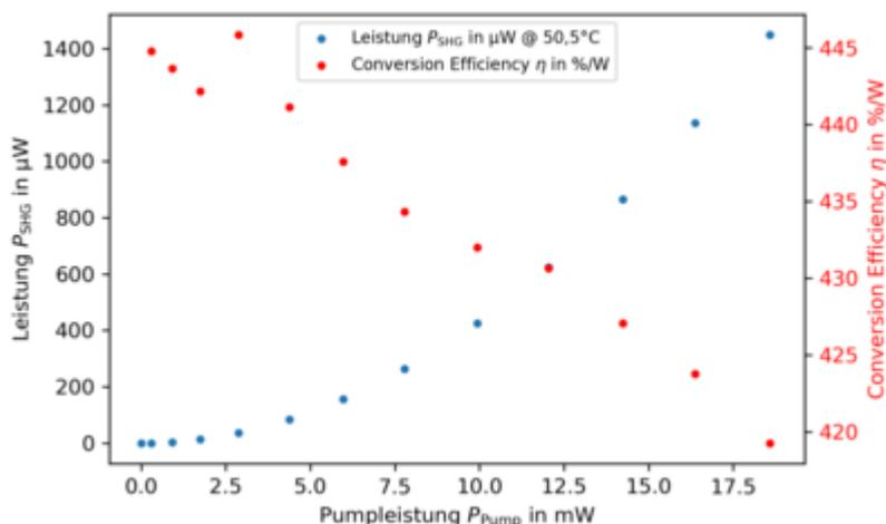
Der Laser wird auf 123.5 mA bei 17.5°C eingestellt und liefert eine Pumpleistung von 19.23 mW bei 1560 nm. Unter diesen Bedingungen wird die Temperaturabhängigkeit der Ausgangsleistung und conversion efficiency des SHG untersucht. Als optimale Temperatur wurde 50.5°C bestimmt.
