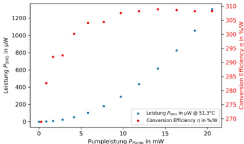
Im Datenblatt wird 51.3 als optimale Betriebstemperatur angegeben. Für diese Temperatur wird die Abhängigkeit der Ausgangsleistung des SHG sowie der conversion efficiency von der Pumpleistung untersucht.
