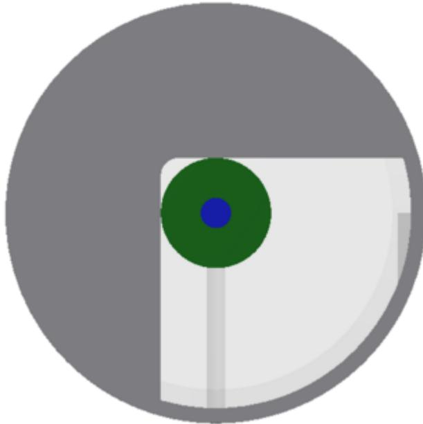
Bei der zweiten Version ist die Optical Mask höher, sodass sie 1 mm über den Spiegel hinausragt. Dies dient dazu, dass der ULE-Ring auf dem Spiegel optisch kontaktiert werden kann.
