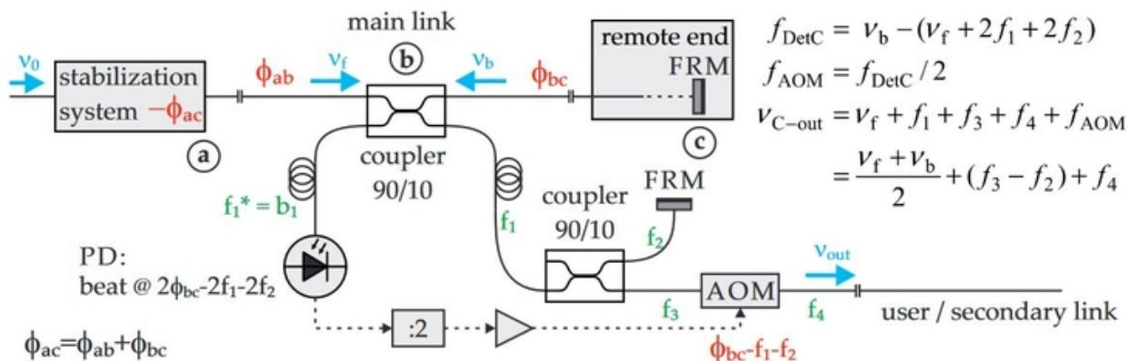
\* Nach Möglichkeit sollten die Strecken  $f_2 = f_3 + f_4$  gleich lang sein, damit die Strecke  $f_3 + f_4$  stabilisiert ist!
